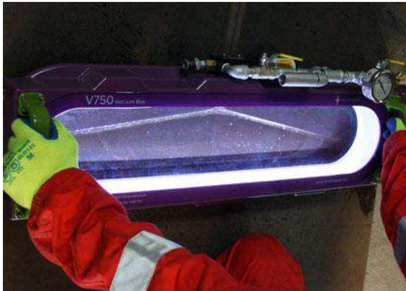
Slika 2.2.7: Preiskava tesnosti zvara z uporabo vakuumske komore.
