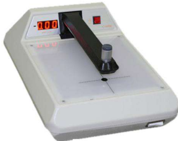
Slika 1.6.9: Densitometer za merjenje počrtnitve radiografskih filmov
