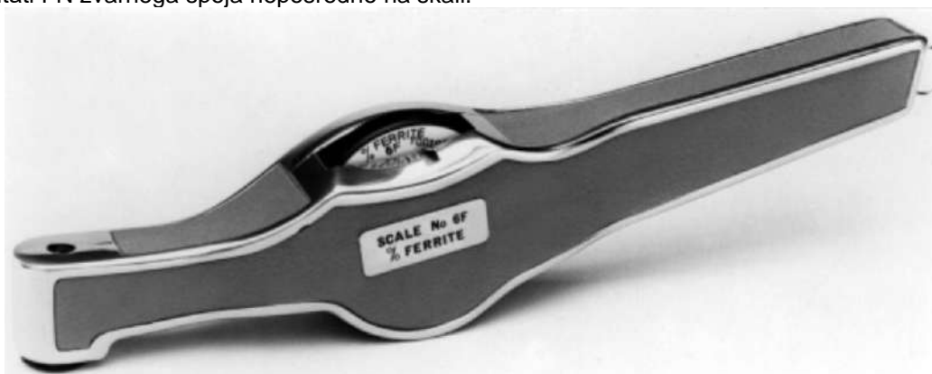
Slika 2.1.26: Prenosni merilnik feritnega števila (FN) na nerjavnih zvarnih spojih
