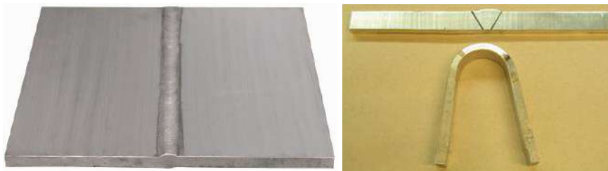
Slika 2.1.1: Vzorci pločevine za mehanske preiskave zvarnih spojev
