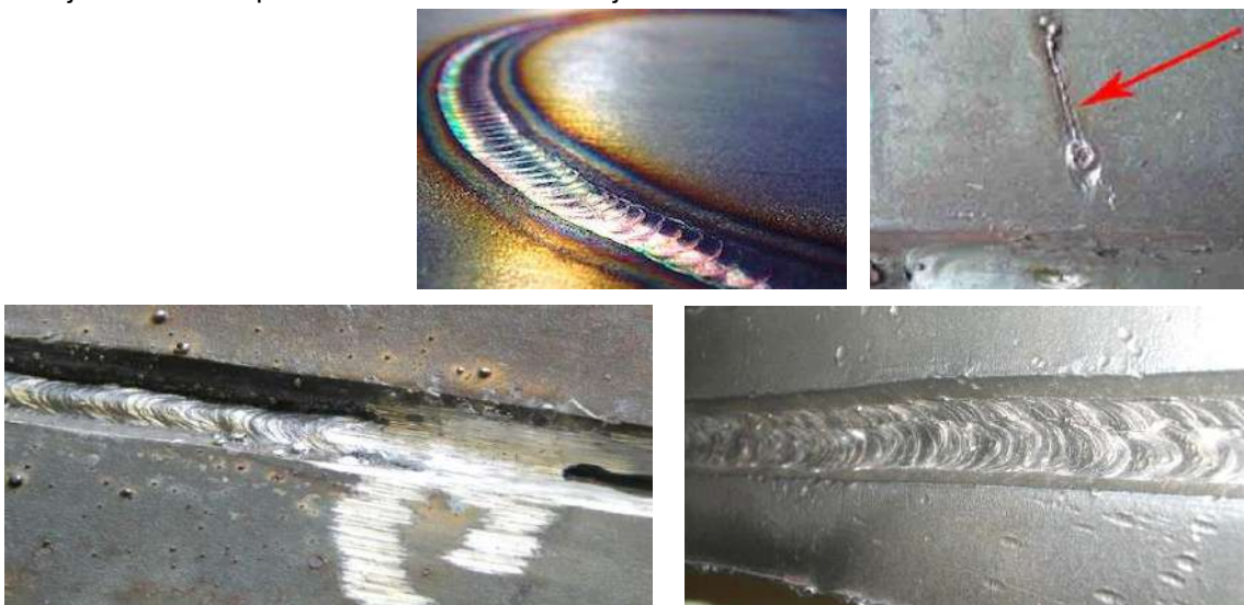
Slika 1.7.29: Primeri drugih nepravilnosti (obrizgi, obarvanost, vzpostavitev obloka, zabrus, zasek)
