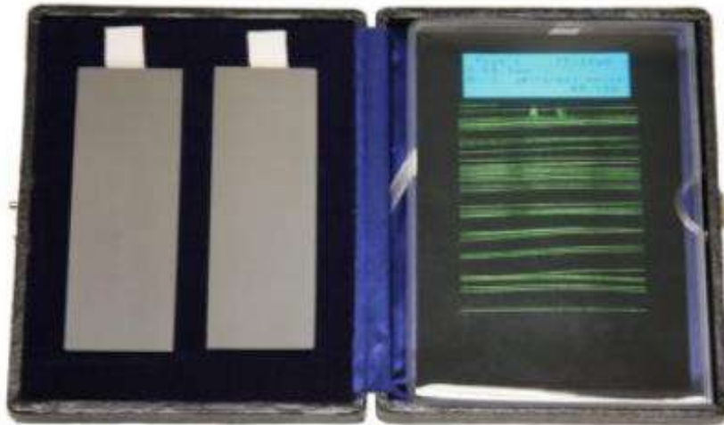
Slika 1.6.12: Referenčni bloki TIP 1 po EN ISO 3452-3 za preverjanje občutljivosti PT sistema
