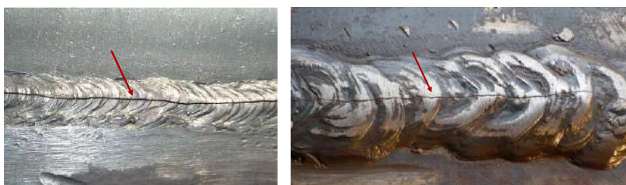
Slika 1.7.11: Primeri razpok v vročem na površini zvara
