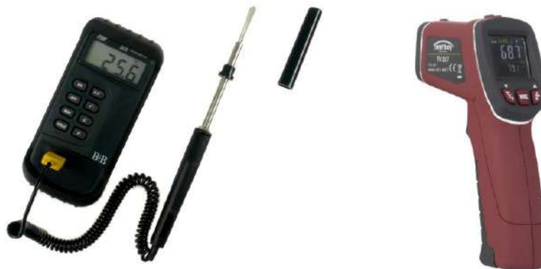
kontaktni termometer s termočlenom Ni-NiCr
