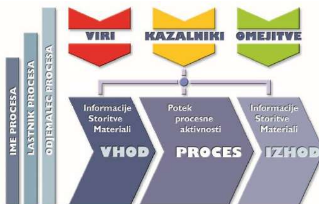
Slika 1.4.1: Shema procesa sistema vodenja kakovosti
